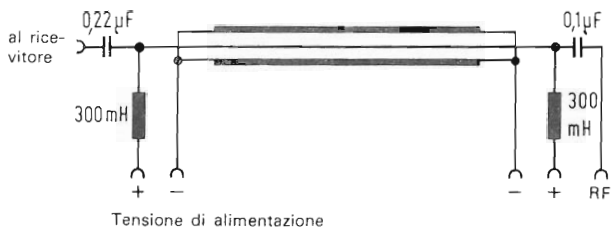
Fig. 3.20 Alimentazione a distanza di un'antenna attiva tramite il cavo coassiale.
